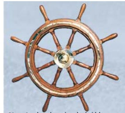
09. Штурвал с восемью спицами и латунным или хромированным фитингом
