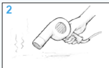
Рис. 7. Высушите поверхность. Дайте влажной поверхности просохнуть или используйте фен для ускорения процесса.
