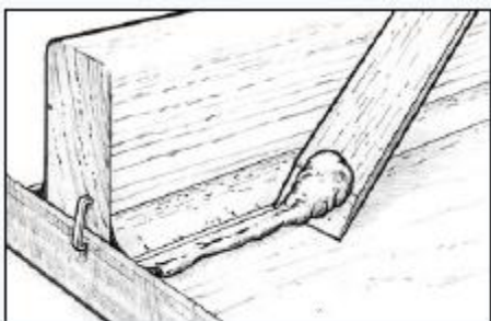
Рис.14. Удалите излишки материала за пределами кромки
